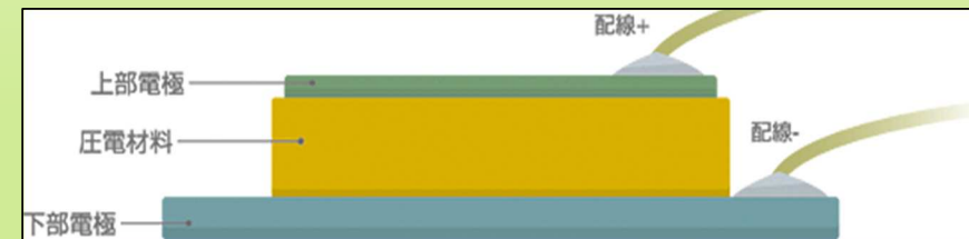
圧電素子の外見と構造
