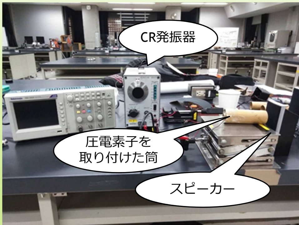
周波数と振動膜発電の関係を求める実験装置
