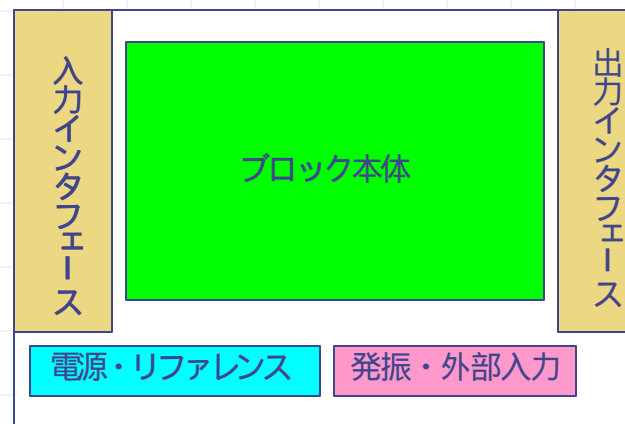
全体の配線方向
