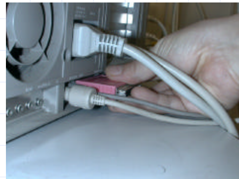
パソコンのプリンタポートに キーを差し込む
