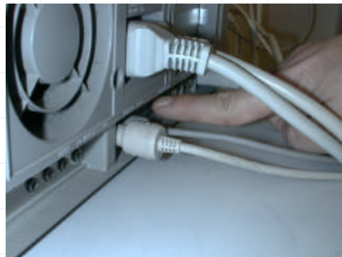
パソコンのプリンタポートに キーを差し込む
